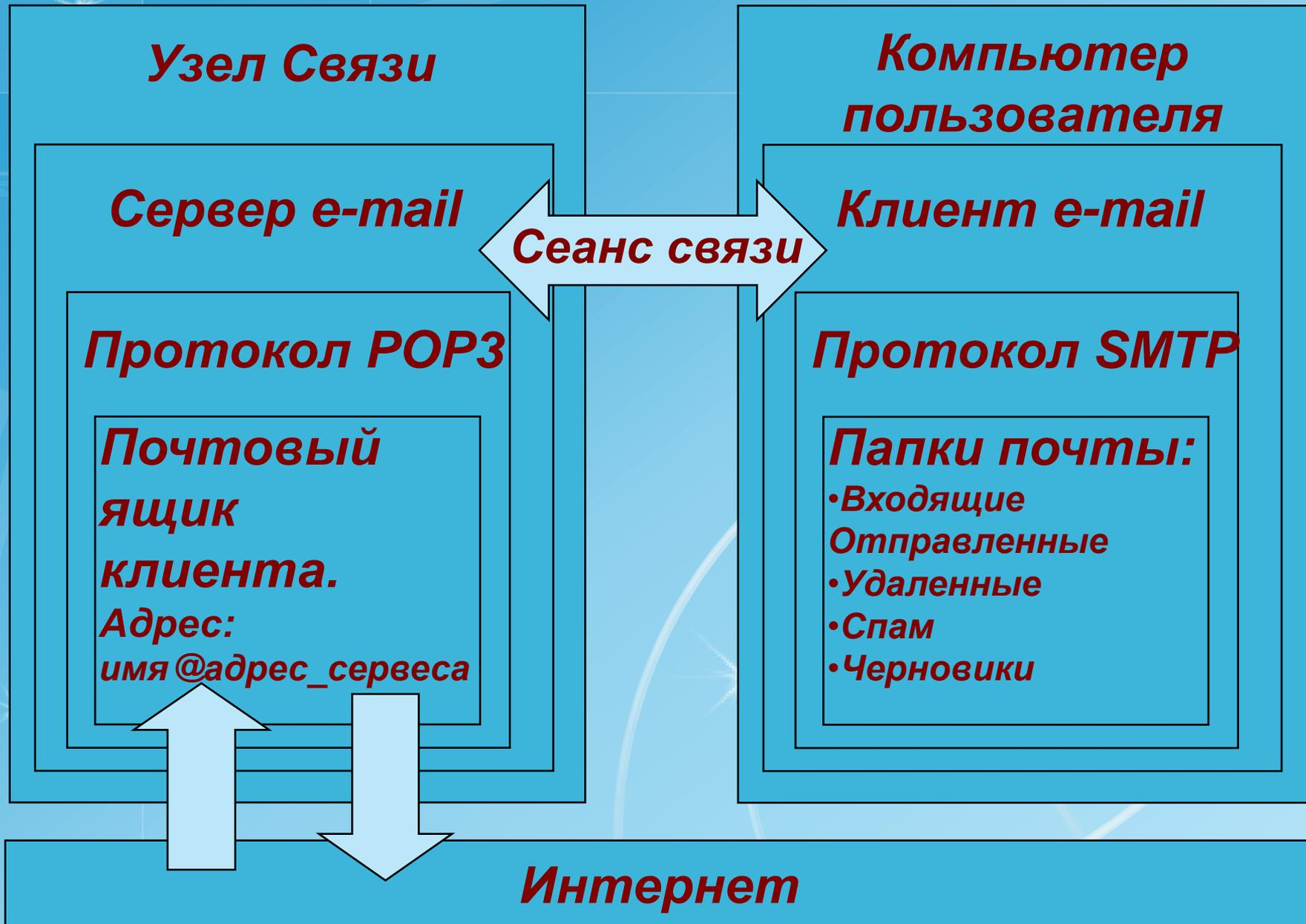
Схема функционирования электронной почты
