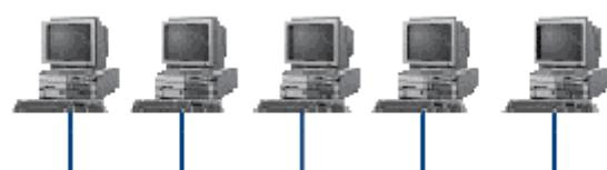
**Шина** (bus), при которой все компьютеры параллельно подключаются к одной линии связи, и информация от каждого компьютера одновременно передается ко всем остальным компьютерам. Согласно
