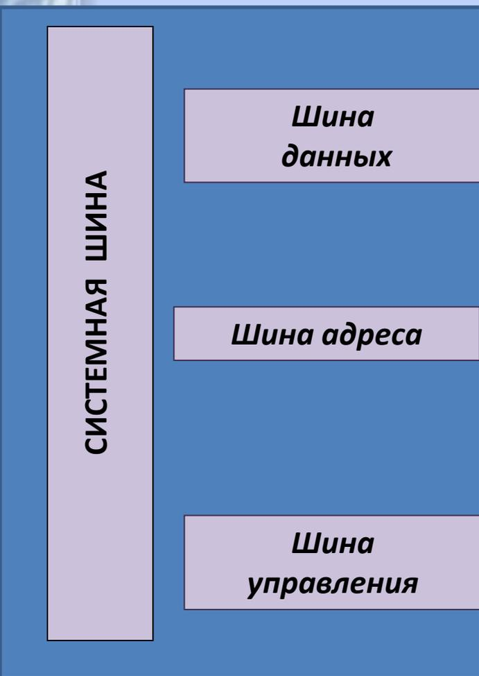
➔ Предназначена для передачи данных между различными устройствами
