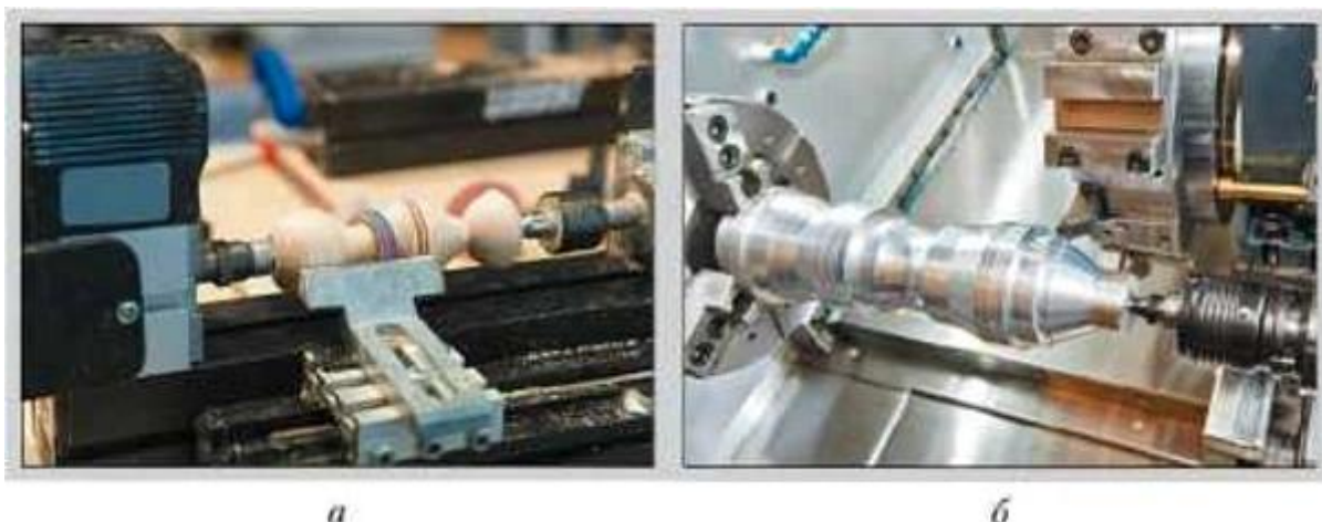
Рис. 20. Токарная обработка материала на станке с ЧПУ: а — древесины; б — металла
