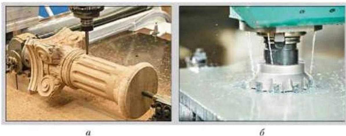
Рис. 19. Фрезерная обработка материала на станке с ЧПУ: а — древесины; б — металла
