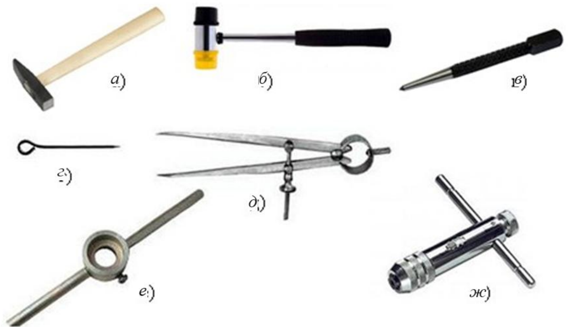
Рис. 11. Вспомогательные инструменты: а – слесарный молоток; б – рихтовальный молоток; в – кернер; г – чертилка; д – разметочный циркуль; е – плашкодержатель; ж – вороток для метчиков
