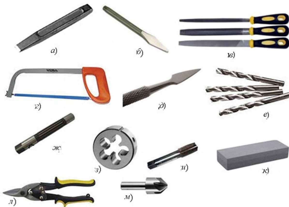
Рис. 10. Режущие инструменты: а – зубило; б – крейцмейсель; в – напильники; г – ножовка; д – шабер; е – спиральные сверла; ж – развертка; з – плашка; и – метчик; к – абразивный брусок; л – ножницы по металлу; м – зенкер
