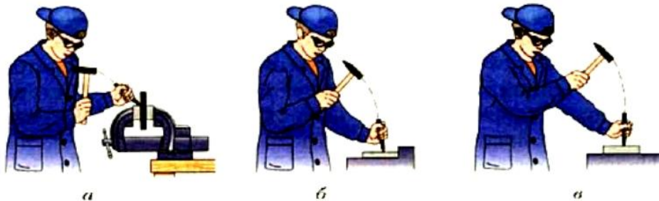
Рис. 3. Приёмы рубки металла в тисках: а — кистевой удар; б — локтевой удар; в — плечевой удар.
